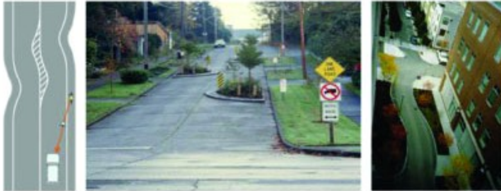
شکل (۹) انواع جزیره های مارپیج کاهش دهنده عرض مسیر
