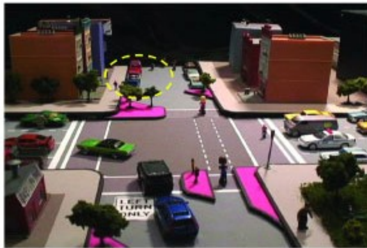
شکل (۱۷) نمونه ای از نیمه منحرف کننده های جریان ترافیک به منظور آرام سازی جریان ترافیک
